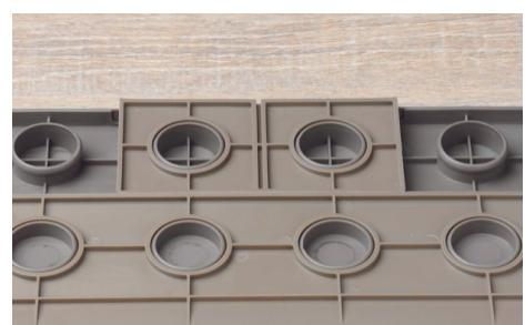
**4** Plaats de connectoren, vierkant en langwerpig, zoals op onderstaande afbeelding. U kunt deze met de hand erop drukken, maar ook door het zwarte kunststof slagplaatje te plaatsen op de connector klikverbinding en deze vast te tikken met een hamer. Zorg voor een stevige vlakke ondergrond. Altijd het slagplaatje gebruiken!
