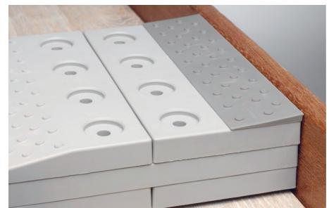
Rode a meia placa de montagem 90 graus e coloque-a sobre uma peça da placa. Fixe com um batimento firme do martelo (utilize sempre a placa batente). Determine onde pode ter de encurtar a placa de montagem com base na melhor altura de montagem. Existem linhas de corte na placa para isso.
