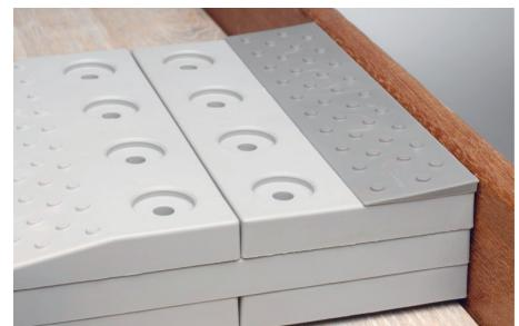
Legen Sie ein halbes Aufsatzstück quer auf das Schwellenstein auf. Schlagen Sie das Aufsatzstück mit einem kräftigen Hammerschlag fest (benutzen Sie dabei unbedingt die Schlagplatte). Bestimmen Sie anhand der gewünschten Höhe die Stelle, an der das Aufsatzstück verkürzt werden soll. Das Aufsatzstück ist dazu mit entsprechenden Einkerbungen versehen.
