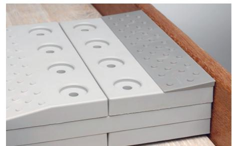
Plaats de halve pastegel dwars op een tegeldeel. Met een stevige klap van de hamer (gebruik altijd het slagplaatje) slaat u deze vast. Bepaal waar u, aan de hand van de best passende hoogte, de pastegel eventueel dient in te korten. In de tegel zijn daarvoor aanwezige snijlijnen aangebracht.
