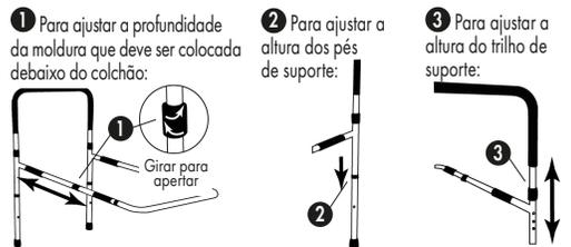
Certifique-se de que os botões estão corretamente alinhados. Os botões devem sobressair completamente através do orifício de ajuste para garantir um bloqueio eficaz.
